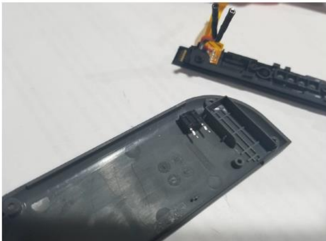
(Obrázek 16 - S použitím tlačítka nalezeno správné místo pro vrtání)
