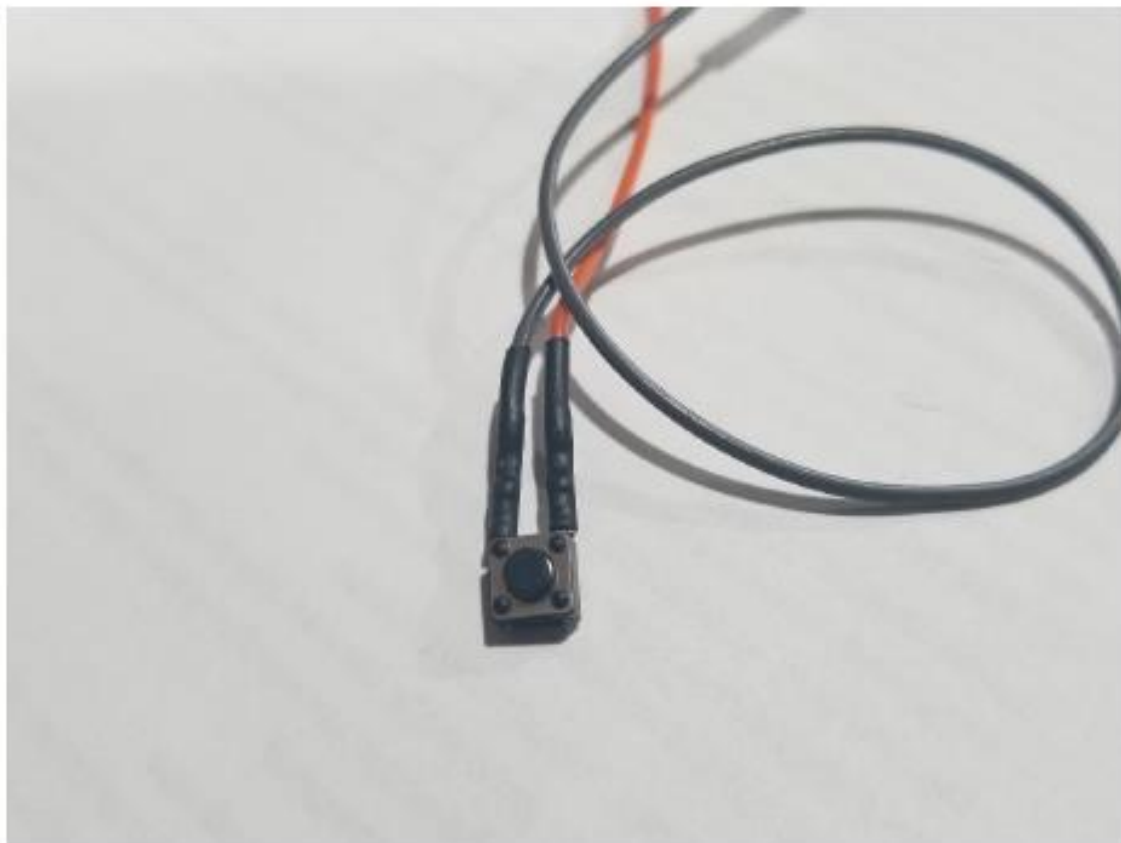
(Obrázek 13 - Tlačítko připojené k drátkům)
