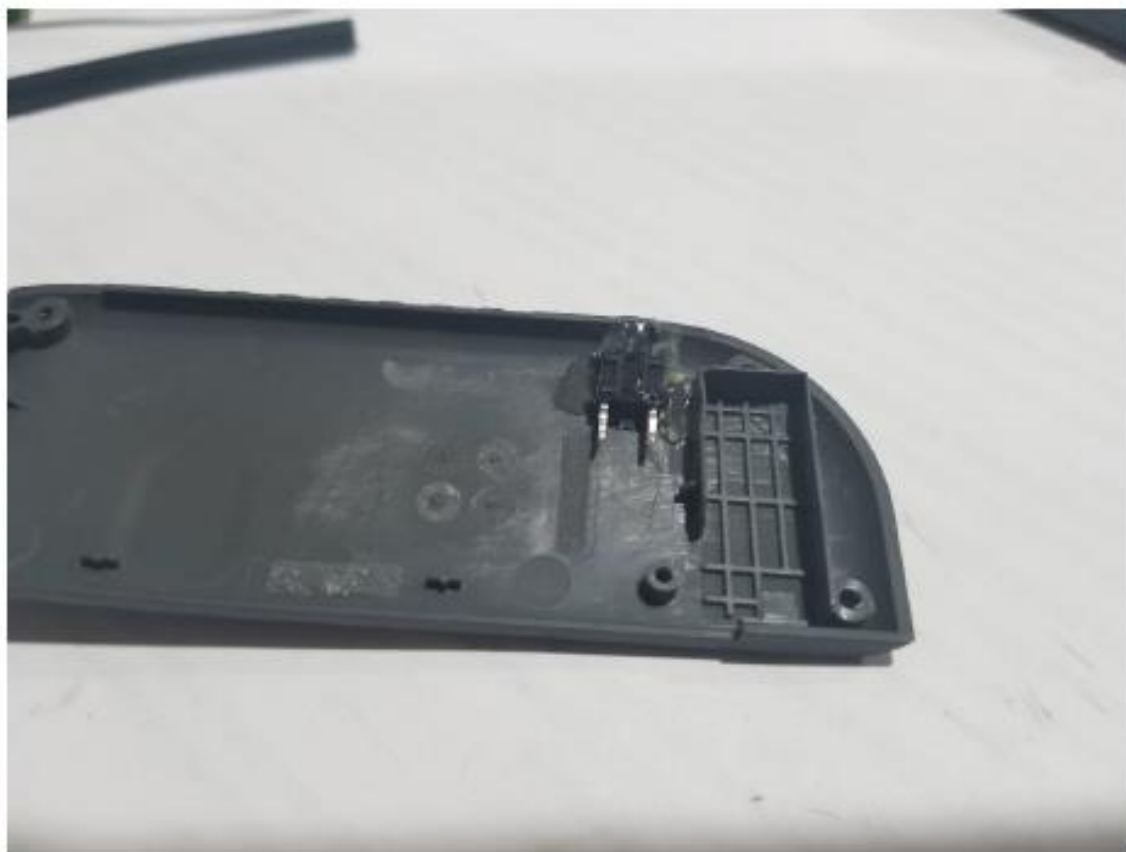
(Obrázek 18 - Tlačítko upevněno pomocí tavné pistole)
