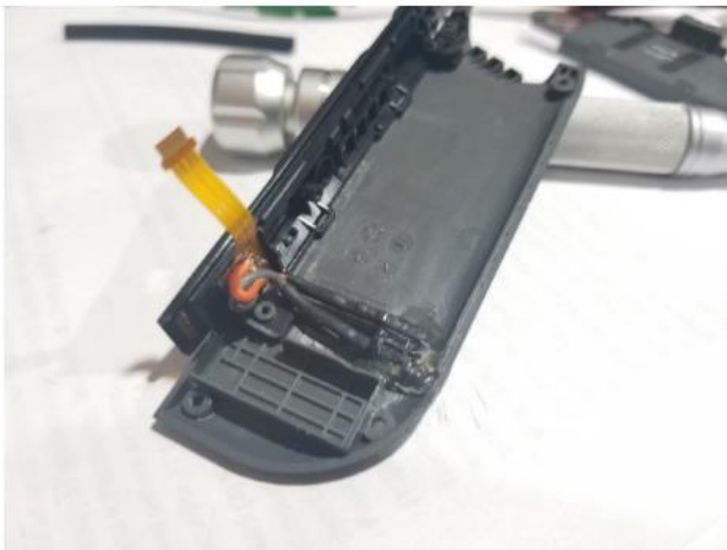
(Obrázek 24 - Destička s konektorem propojená s tlačítkem a upevněná ke krytu)
