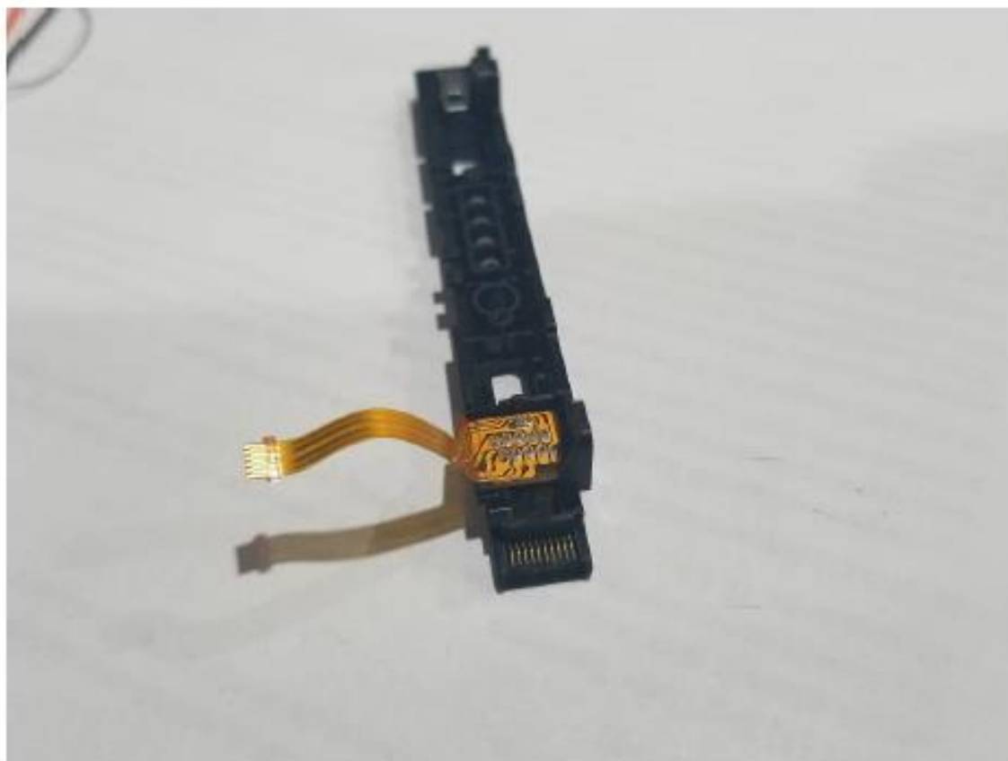
(Obrázek 15 - Odstraněna boční destička s konektorem)
