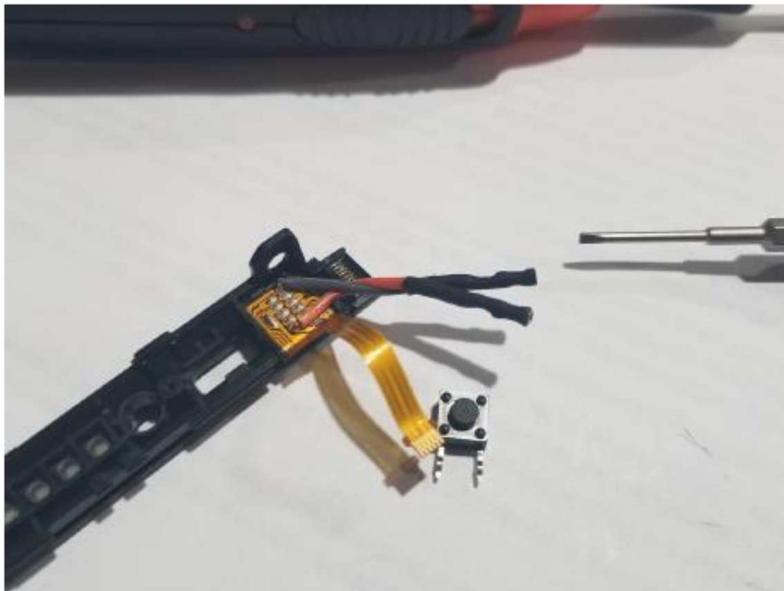
(Obrázek 23 - Napájené drátky na destičku s konektorem)
