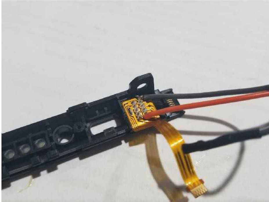
Slika 22 – kablovi zalemljeni na platini šine
