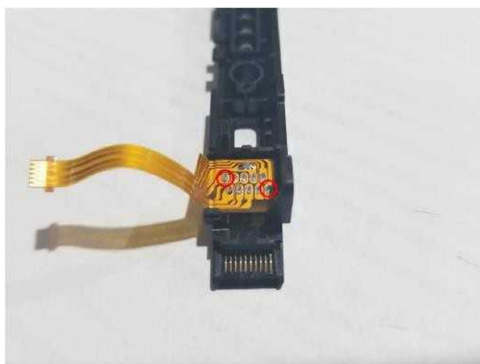
slika 21 – tačke lemljenja za Pin 1 i Pin 10
