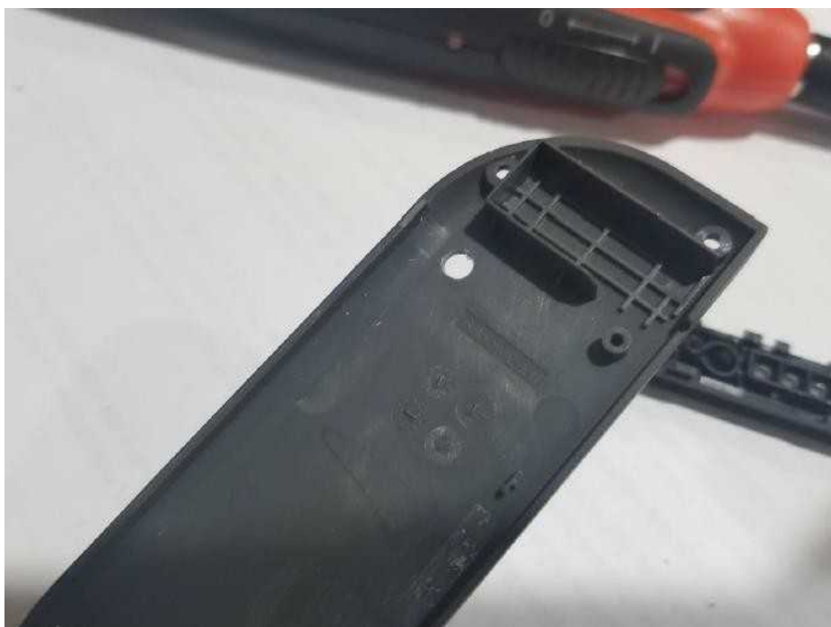
Slika 17–Izbušena rupa (malo previše lijevo)
