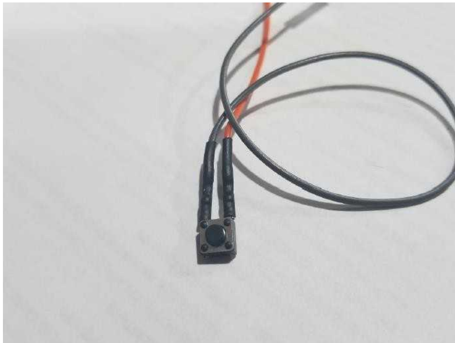
Slika 13 – Prekidač sa spojenim kablovima
