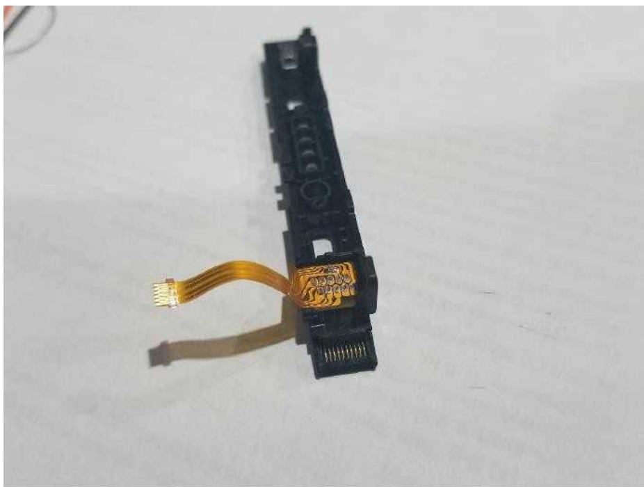
Slika 15 – odpojena šina joycon kontrolera
