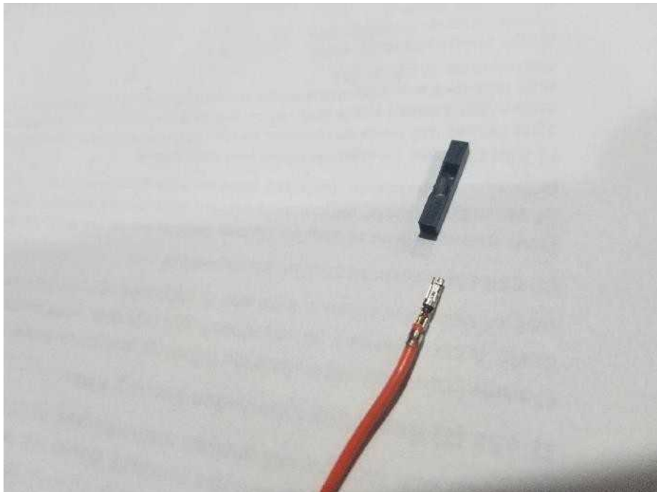
Slika 4 – kabel sa skinutom plastikom
