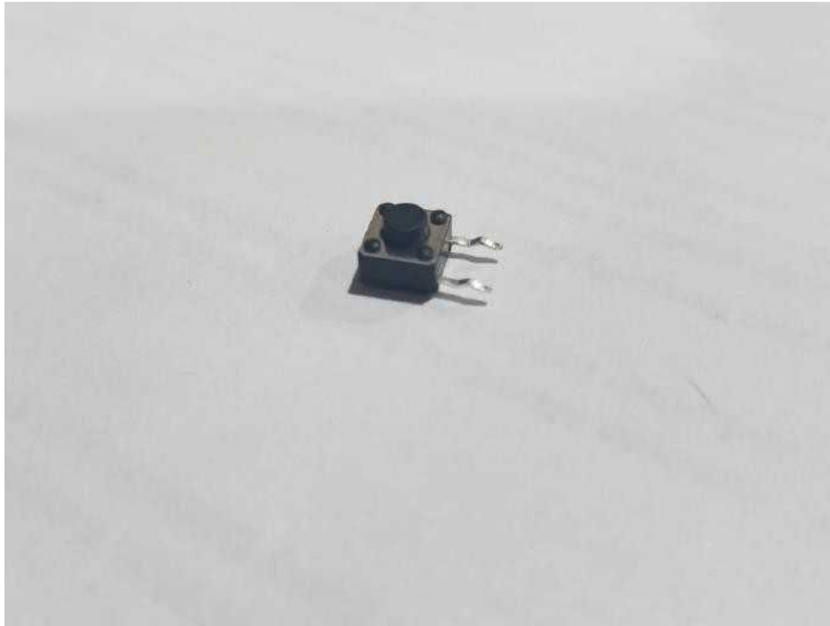
Slika 12 – Prekidač sa ispravljenim nožicama
