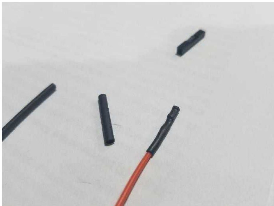
Slika 7 – izolaciona cijev istopljena na kablu
